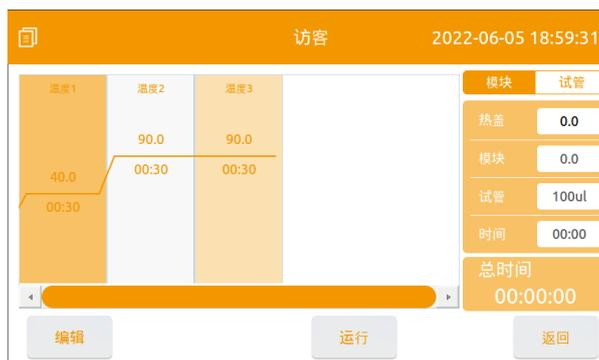
程序在运行过程中可以点击按钮栏中“暂停”按钮来暂停运行；点击“继续”按钮继续运行。点击“跳过”来跳到下一步程序步工作。点击“停止”停止程序运行。运行界面如下图所示。
