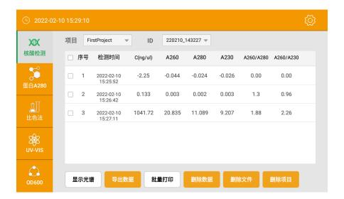
开机前插入打印机 usb,连接打印机,开机检测样品后,勾选需打印的数据,点击批量打印按钮,即可打印检测数据。可多条同时打印。
