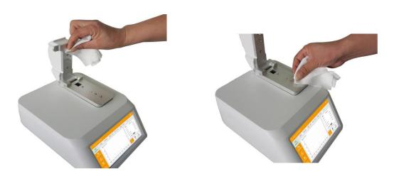
【注】: 测试结束后,请用纯净水清洗检测头3次。
