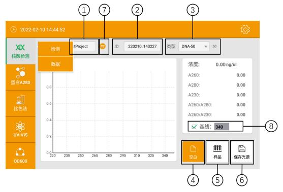
上图所示界面中,左侧顶部为核酸检测界面、数据两个选项,可点击相应区域进入各自功能区。
