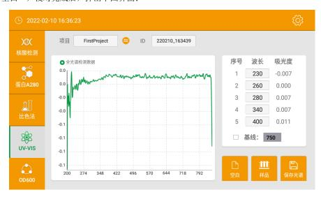
② 在 Uv-Vis 检测初始界面右侧区域,如下图,可根据需要在输入框中输入特征波长,样品检测完成后显示该波长的吸光度,波长输入必须在样品检测之前,之后无效。
