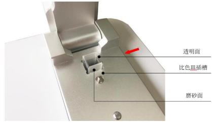
【注】: 图中箭头方向为检测(光照)方向,比色皿插入插槽时透明面应与箭头方向垂直。
