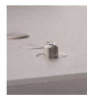
【注】:检测时,液体样本的使用量不是检测准确的关健因素,但是必须保证上基座与下基座之间能形成完整的液柱,这样才能确保检测的准确性。取样时最好使用量程为(0-2  $\mu$ L)精密移液器和 tip 头来取样,确保取样的准确性。如果对样本的特征或者移液器精确性不太确认,最好使用 2  $\mu$ L 样本量来做检测。
