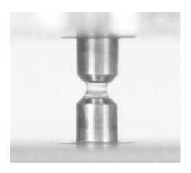
c) 检测完成后, 抬起上基座, 用干净的无尘布把上下基座上的样品擦干净, 以免样品残留影响下次检测。
